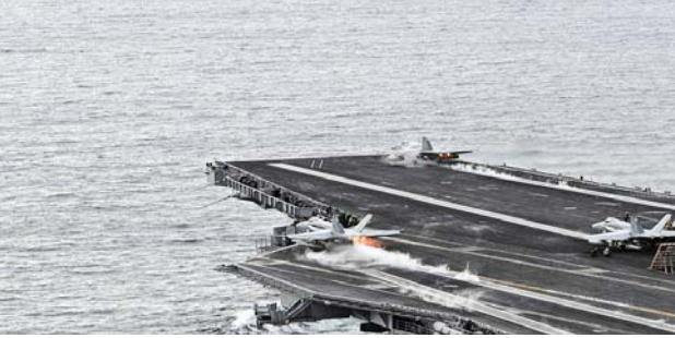
12 - إقلاع طائرات مُقاتلة من على سطح حاملة الطائرات الأمريكية «يو إس إس رونالد ريغان» باستخدام منجنيق نظام «كاتوبار»
